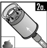
2a. Nachfüllnippel Art. 290.3012 aufschrauben und Fettpresse anschliessen, oder Anschlussnippel Art. 290.3013 bzw. 290.3014 auf Fettpresse aufschrauben. Der Spender wird dabei während dem Füllvorgang gegen den Adapter gedrückt gehalten. Dadurch entfällt das wiederholte Aufschrauben des Nachfüllnippels. Fett in den Spender pressen.
